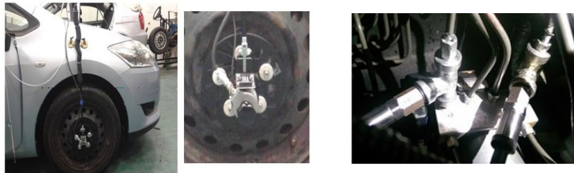
Şekil 1. Enkoderin taşıta bağlanması ve basınçölçer
